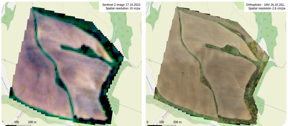
图4：10m分辨率哨兵-2卫星真彩色图像和2.8cm分辨率无人机正射影像对比。后者可以清晰看见侵蚀沟，也可用于进一步分析如侵蚀量计算。
