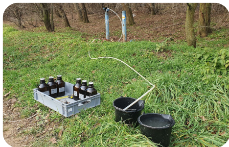
Фиг. 2: Вземане на проби от плитки подпочвени води за мониторинг на нитрати.
