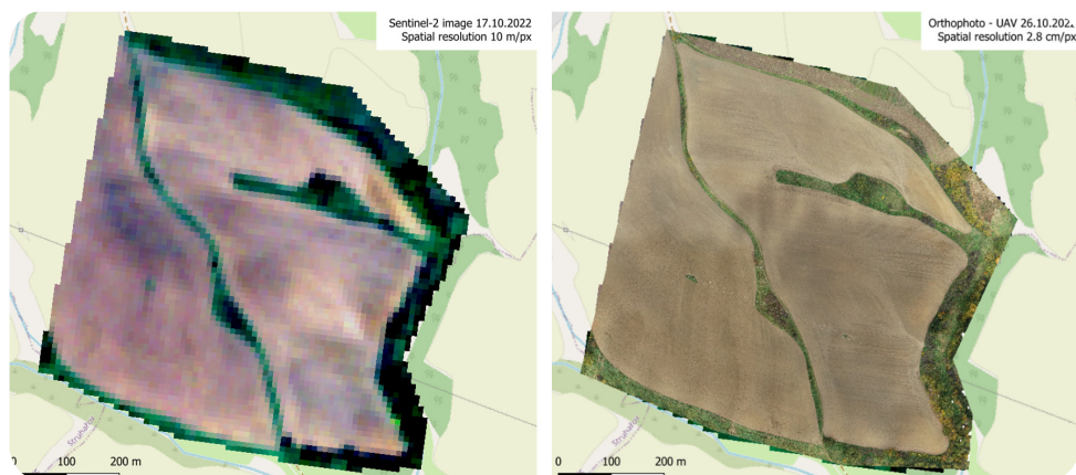
Фиг. 4: Сравнение на сателитно изображение в реални цветове Sentinel-2 с разделителна способност 10 м/пиксел и ортофотокарта, заснета от безпилотен летателен апарат с разделителна способност 2,8 см/пиксел, с видими ерозионни бразди, които могат да се използват и за по-подробен анализ, например за изчисляване на ерозиралия материал.
