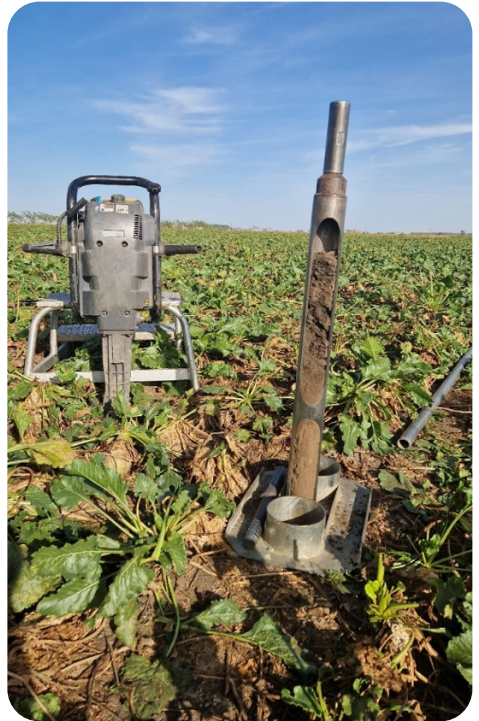
1. Ábra: Fúrásos, bolygatatlan talajmintavétel a talaj nitrátraprofiljának vizsgálatára, szántóföldön.
