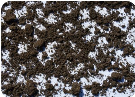
图1：表土层壤土的团粒结构（黑钙土）。
