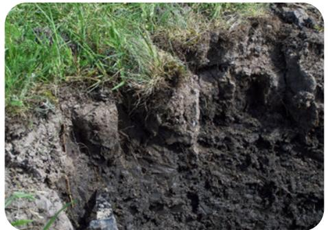
图3：粘土（Solonetz）的柱状结构。
