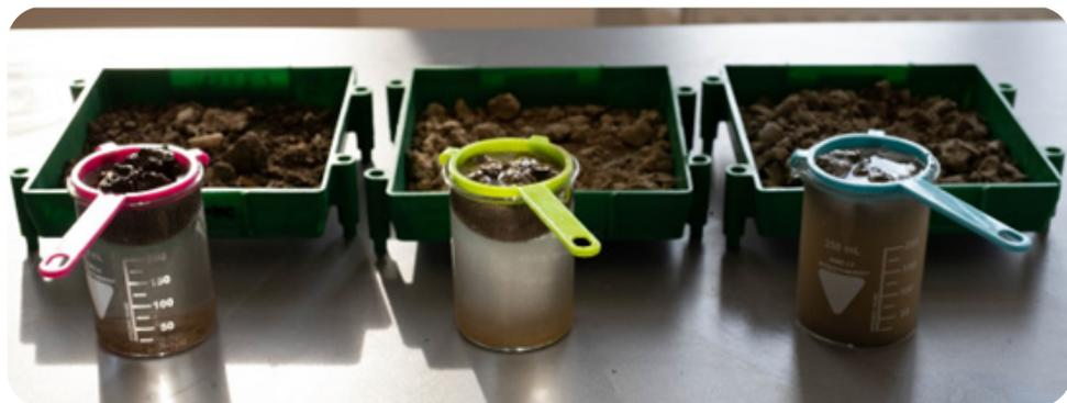
图4：土壤团聚体稳定性试验结果（见TUdi DSTapp），使用滤网、玻璃杯和水。土壤结构的稳定性从左到右降低。
