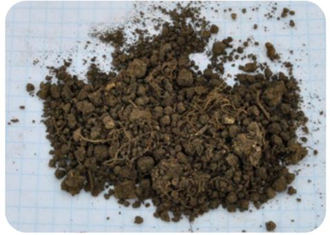
**Abb. 2:** Gut ausgeprägtes subanguläres Blockgefüge eines lehmigen Bodens (Tschernosem).
