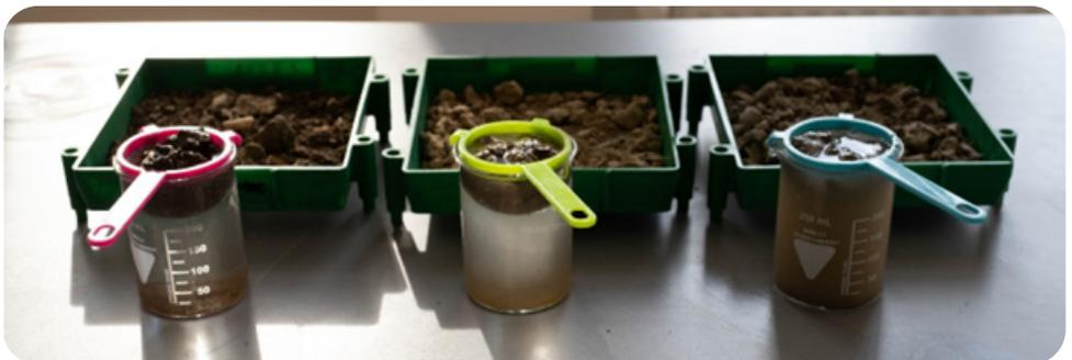
**Abb. 4:** Ergebnisse des Bodenaggregatstabilitätstests (siehe die TUDI DST-App) unter Verwendung von Teesieb, Glas und Wasser. Die Stabilität der Bodenstruktur nimmt von links nach rechts ab.
