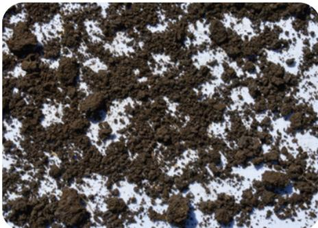
**Abb. 1:** Körnige Struktur des Lehmbodens im Oberboden (Tschernosem).
