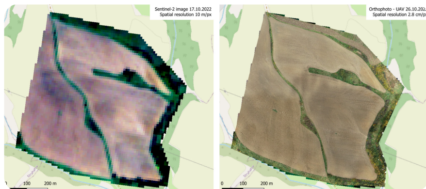
Fig. 4: Confronto tra l'immagine satellitare a colori reali di Sentinel-2 con risoluzione di 10 m/pixel e la mappa ortofotografica scattata da un drone con risoluzione di 2,8 cm/pixel con solchi di erosione visibili, che può essere utilizzata anche per analisi più dettagliate, ad esempio il calcolo del materiale eroso.
