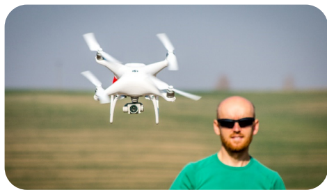
Fig. 2: I droni piccoli ed economici possono ora acquisire dati ortofotografici con una risoluzione a livello di centimetri per pixel.
