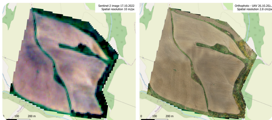
Fig. 4: Comparación entre una imagen satelital en colores reales de Sentinel-2 con una resolución de 10 m/píxel y un mapa ortofoto tomado por UAV con una resolución de 2.8 cm/píxel, donde se observan surcos de erosión visibles, que también pueden utilizarse para un análisis más detallado, como el cálculo del material erosionado.
