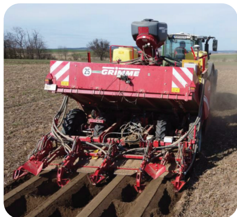
图1：带横坝填脊机的马铃薯种植机。
