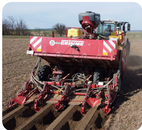
Fig. 1: Plantación de patatas con aporcador transversal.
